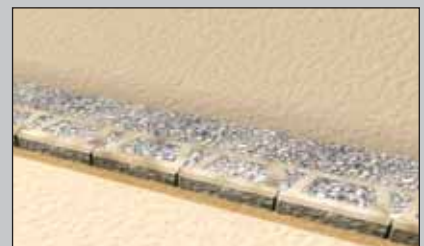
Aanvullen gebroken grind en aanvulgrond
