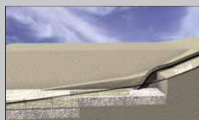
Verdichten en waterpassen van het grind
