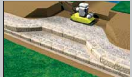
Aanvullen en verdichten
