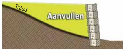
Wand onderaan talud
