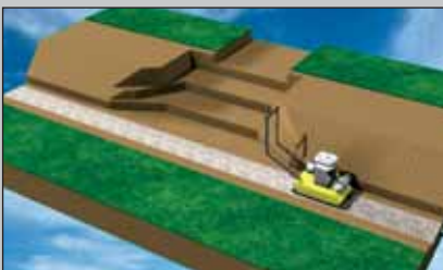
Aanvullen en verdichten
