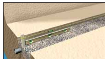
Leg de drainagebuis, aanvullen met grind en egaliseren (met waterpas)
